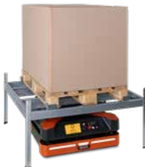
FTS-Palettenbock zur Beförderung von Paletten
